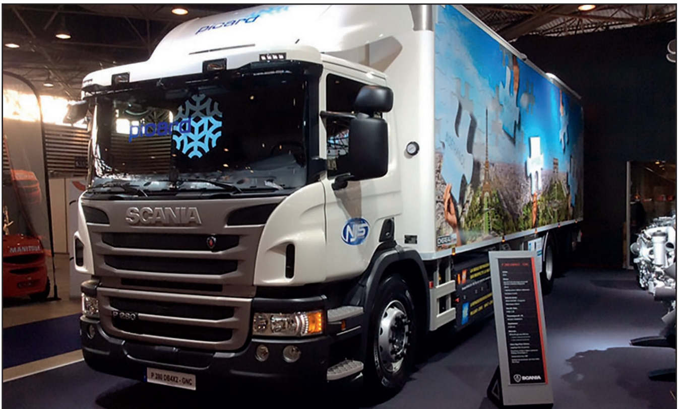
Camion frigorifique Picard fonctionnant au Biogaz
